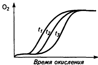
Рис. 16.3. Кинетические кривые окисления полимеров при трех разных температурах: t_1 > t_2 > t_3
