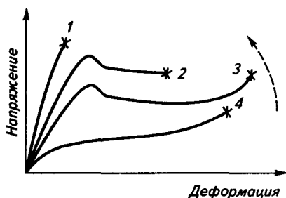
Рис. 10.13. Влияние температуры или скорости деформации на форму кривой напряжение—деформация кристаллического полимера: направление уменьшения температуры (от T_4 до T_1 ) или роста скорости деформации (в том же порядке) указано стрелкой. Звездочкой обозначена точка, в которой происходит разрыв образца
