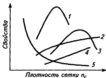
Рис. 17.5. Характерные зависимости свойств эластомеров от плотности образующейся при их вулканизации сетки поперечных связей ( n_c — число отрезков цепей между узлами сетки):
