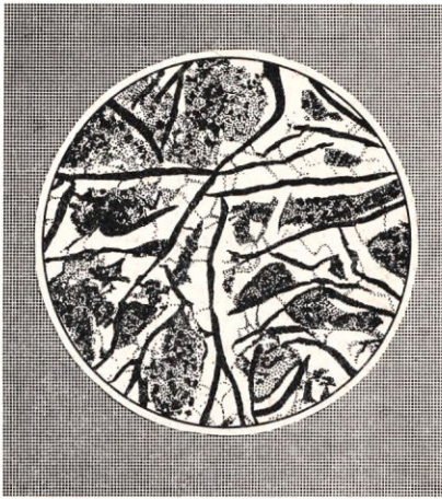
Рис. 48. Серый чугун под микроскопом.
