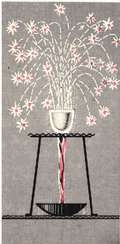
Рис. 47. Восстановление алюминием железа из его окалины.
