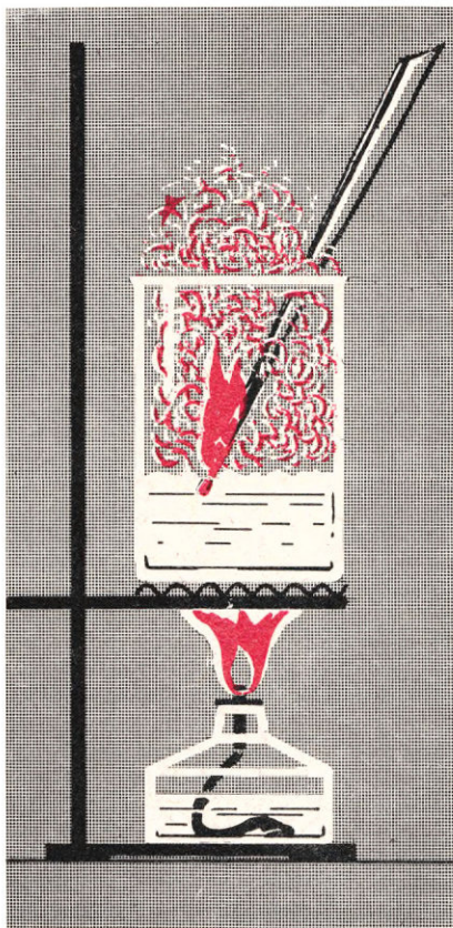
Рис. 13. Горение лучинки в азотной кислоте.
