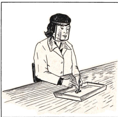
Рис. 40. Металлический натрий легко режется ножом.
