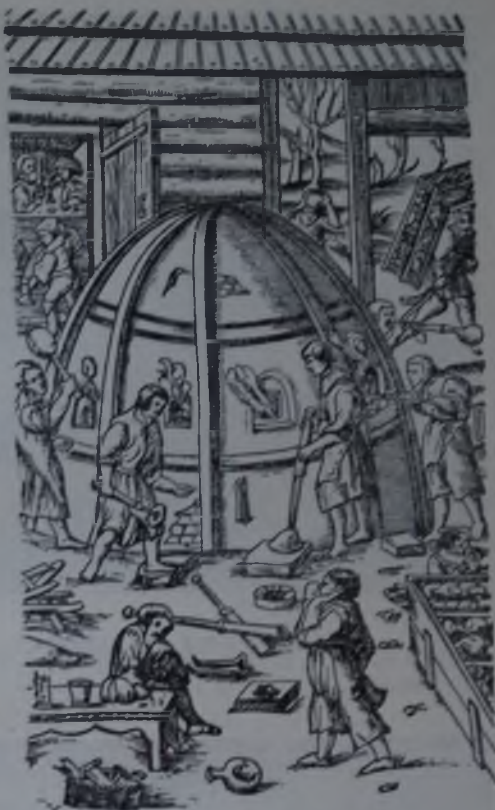
Рис. 134 Печь для выплавки стекла (из книги Агрикола «Металлургия», XVI в.).
