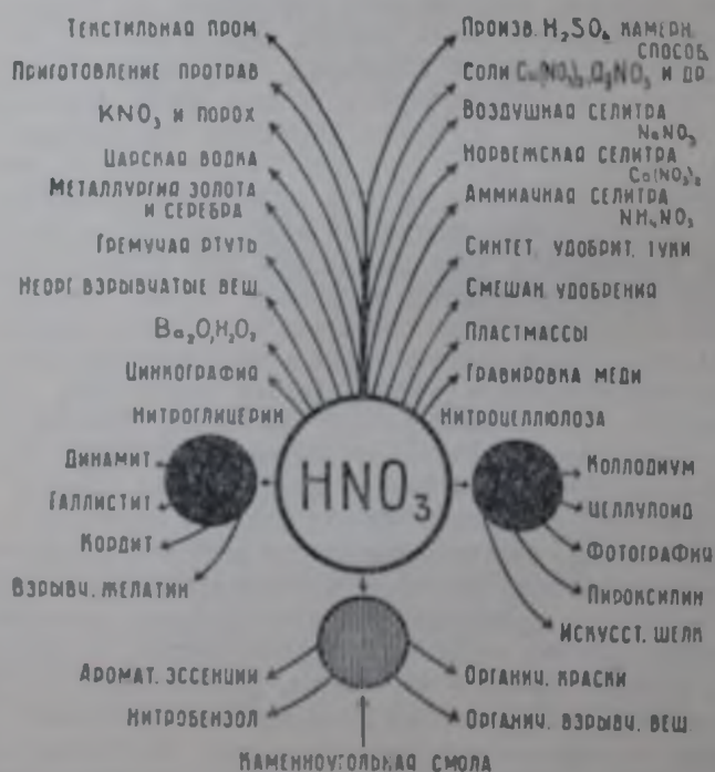
Рис. 112. Схема применения азотной кислоты.
