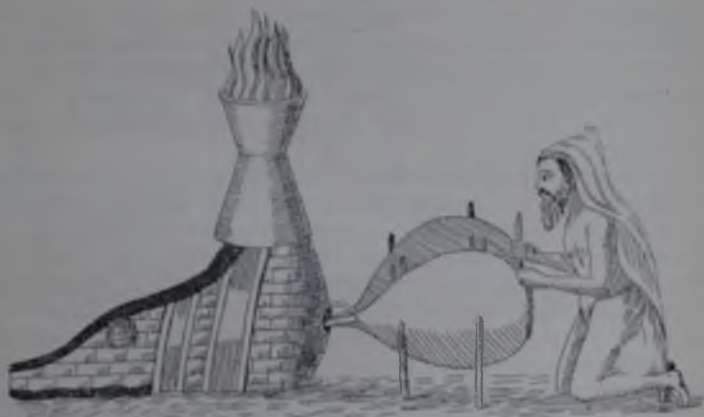
Рис. 7. Печь для выплавки железа у древних персов.
