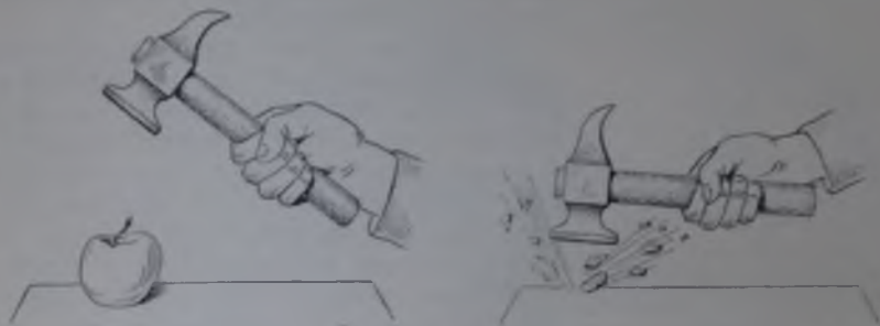
Рис. 71. Разбивание молотком замороженного в жидком воздухе яблока.
