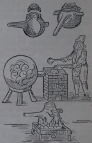
Рис. 93. Получение купоросного масла путём перегонки сернокислого железа, по Глауберу (1648 г.).
