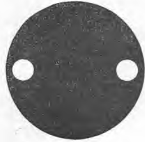
Рис. 66. Маска для объектива микроскопа, которая упрощает фокусировку при работе по методу кажущейся толщины.
