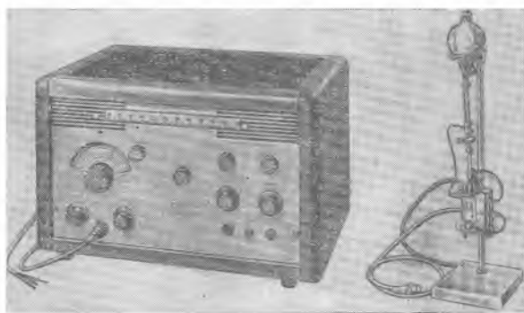
Р и с. 170. Управляемый вручную прибор для полярографического анализа. Слева — общий вид; справа — полярографическая ячейка в собранном виде.
