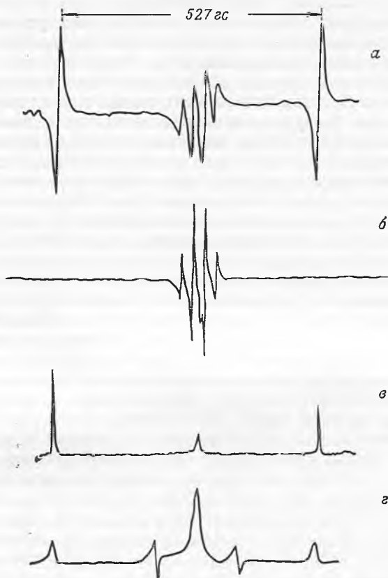
Р и с. 187. Спектры ЭПР \gamma -облученных при 4,2^\circ \text{K} метана, водорода и дейтерия. а — метан; б — метан после частичного нагрева; в — водород; г — дейтерий.
