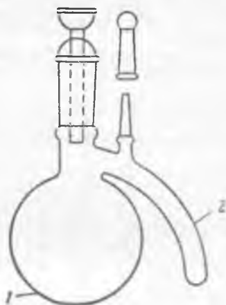
Р и с. 2. Реакционная колба. 1 — круглодонная колба емкостью 50 мл; 2 — боковой отросток емкостью 10 мл.
