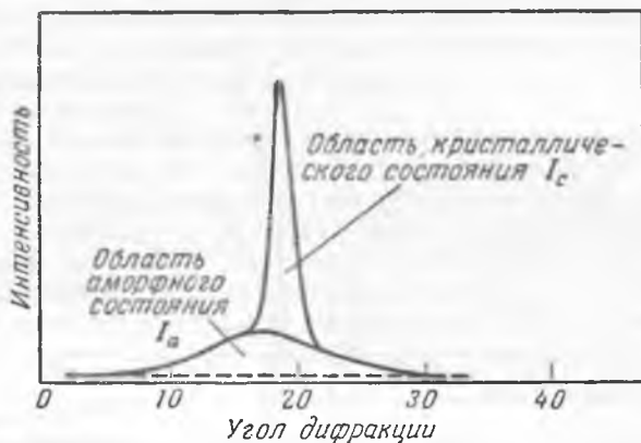
Р и с. 4. Кривая дифракции рентгеновских лучей политетрафторэтилена.
